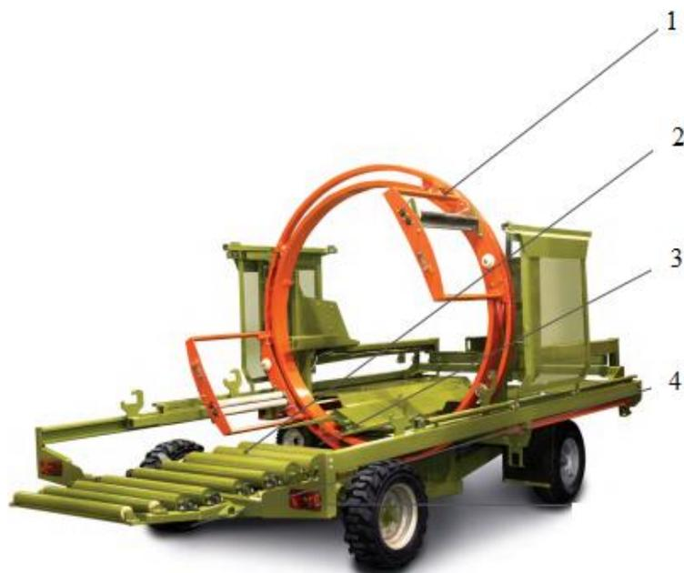
1 - натяжное устройство для плотной обмотки рулонов; 2 – наклонный механизм; 3 – двигатель внутреннего сгорания с электростартером; 4 – стояночный тормоз.
