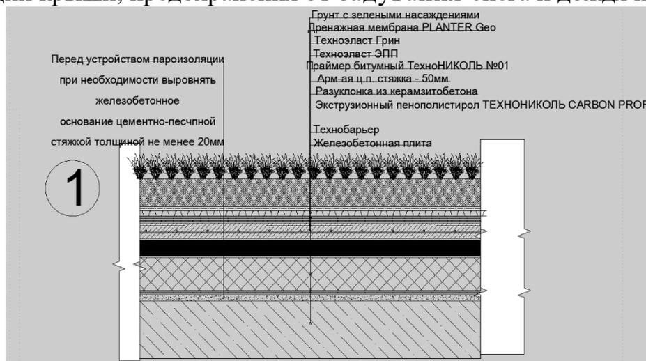
**Рисунок 4 – Устройство крыши под озеленение**
